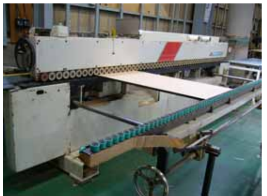
写真2 - 8 エッジテープの接着加工
