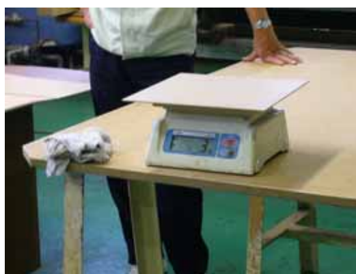
写真2-2 接着剤塗布量の秤量
