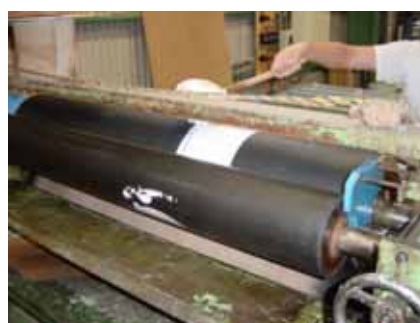
写真 3 - 2 スプレッターへの接着剤流し込み
