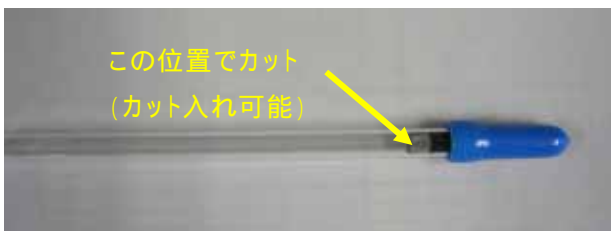
写真 3 -19 捕集管の取り出し
