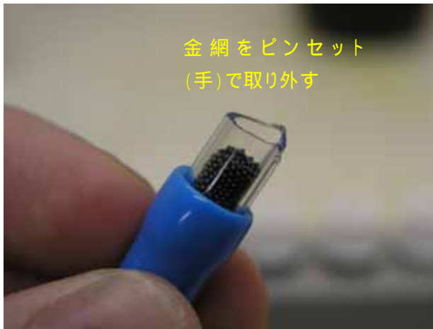
写真 3 -20 捕集管から金網の取り出し
