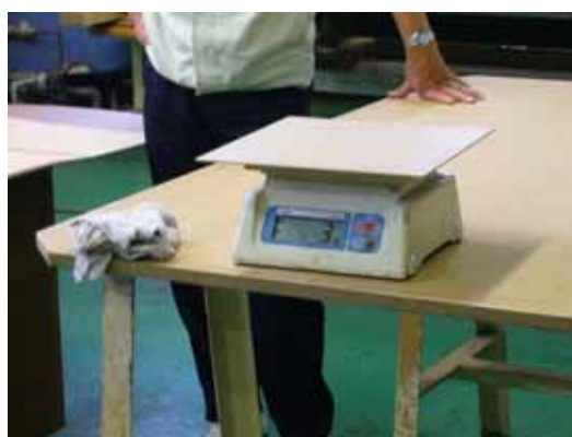
写真2-2 接着剤塗布量の秤量
