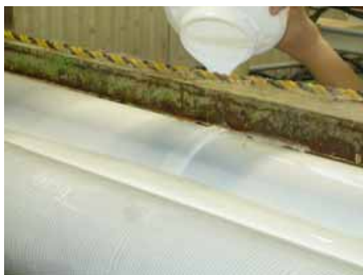
写真2-1 スプレッターへの接着剤流し込み
