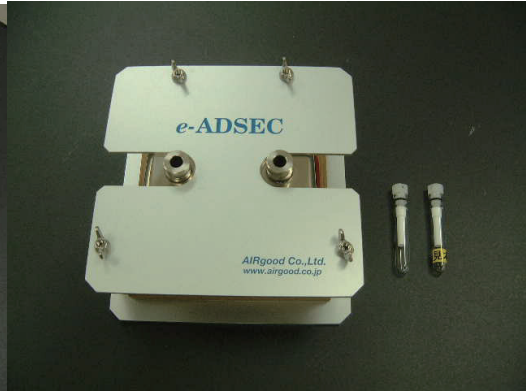
写真15. パッシブフラックス試験装置 写真16. パッシブフラックス装置組み立て これらの測定および解析は分析試験機関に依頼した。
