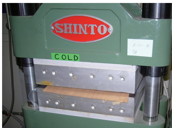
写真4. 冷圧プレスによる圧縮接着
