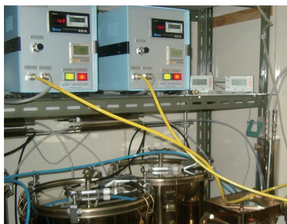
写真11. 小形チャンバー法測定装置
