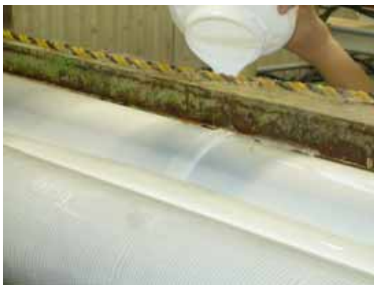
写真 2 - 1 スプレッターへの接着剤流し込み
