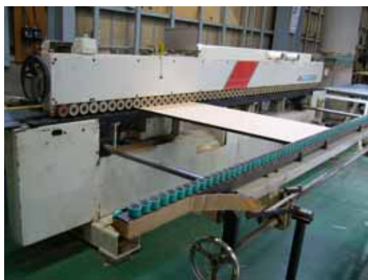
写真 2 - 8 エッジテープの接着加工
