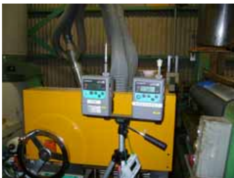
写真 2 - 1 7 スプレッター近辺の空気質測定
