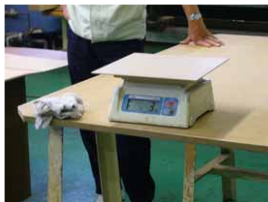
写真 2 - 2 接着剤塗布量の秤量
