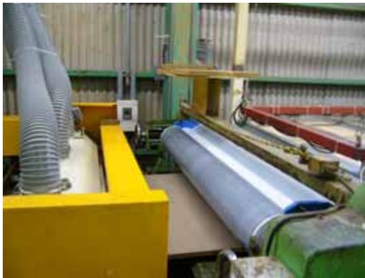
写真 2 - 3 基材への接着剤塗布
