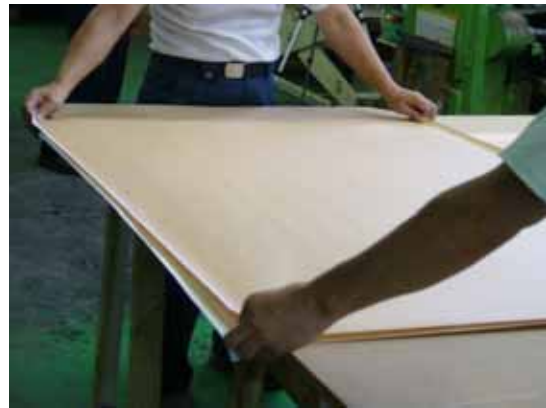
写真 2 - 4 接着面へのコート紙の載置
