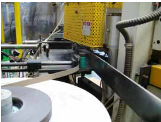
写真 2 - 7 エッジテープの送り込み
