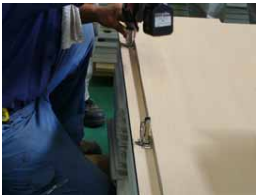
写真 2 - 2 4 扉へのヒンジ取り付け
