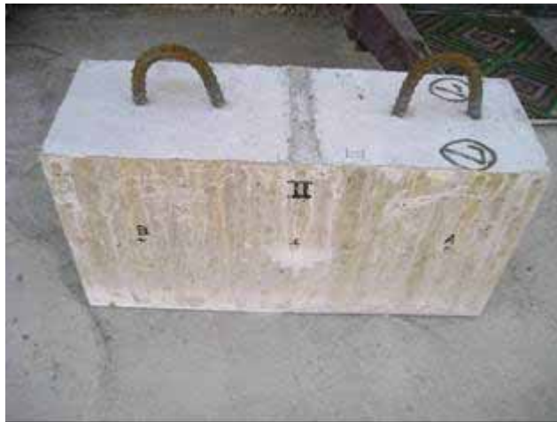
写真 3.3.11 コンクリート表面の仕上がり状況
