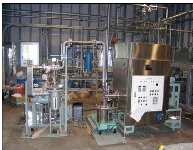
写真 4.3.2 木粉液化装置 (酸触媒型ミニプラント)
