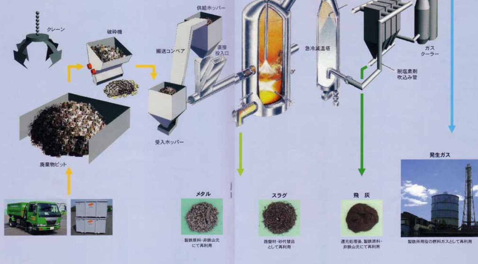
図 2.4.3 住友金属式ガス化溶融プロセスフロー
