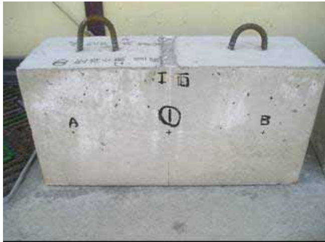
写真 3.3.5 コンクリート表面の仕上がり状況
