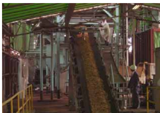
写真 4.5.4 破砕後のコンベア搬送 (写真上部は吊下げ型磁選機)
