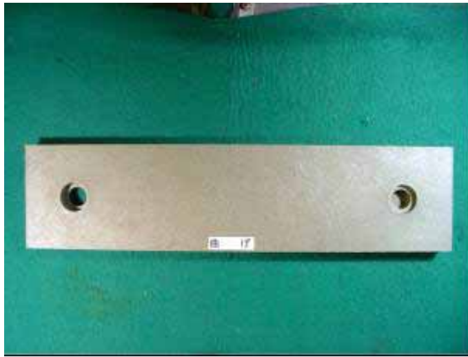
写真 3.3.16 採取した試験片(曲げ試験用)
