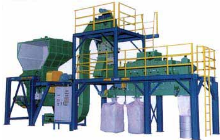
図 4.3.28 石膏ボード専用処理設備 (『渡部工業(株)ホームページ』より)
