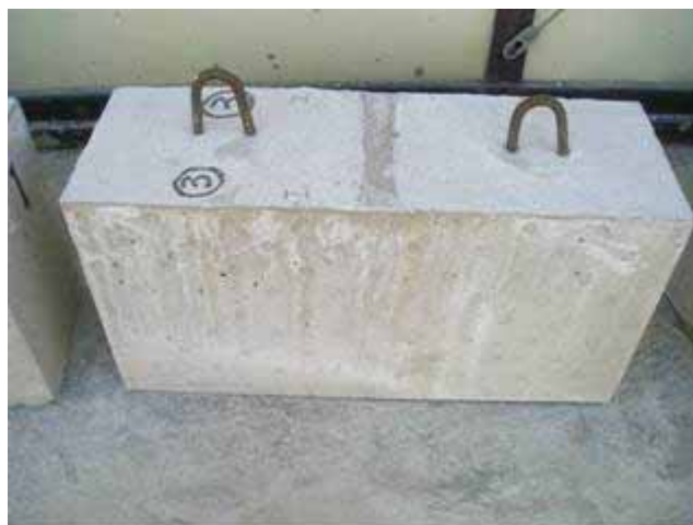
写真 3.3.7 コンクリート表面の仕上がり状況
