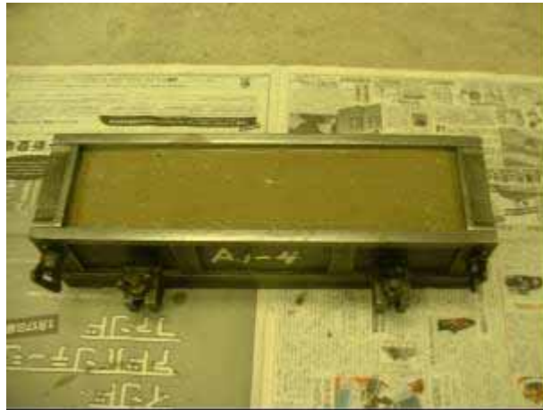
写真 3.3.17 モルタルの打設状況(耐久性)
