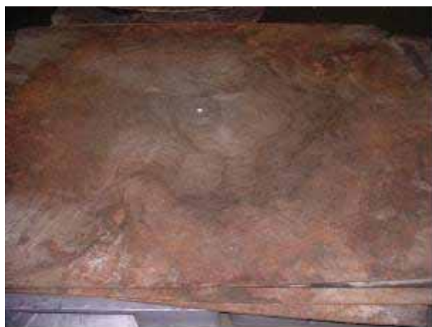
写真 3.3.12 試作コンクリート用型枠パネル (木粉混入率 1 0 %)
