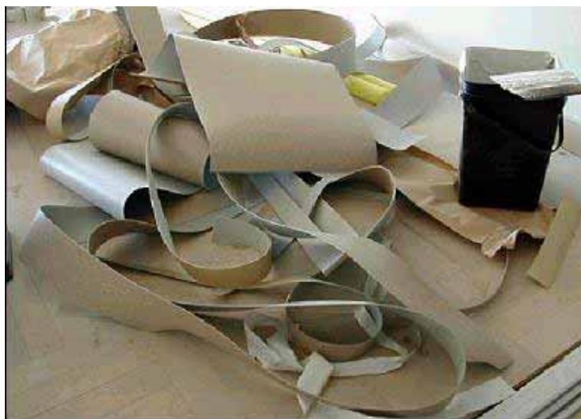
図 2.3.9 長尺シートの施工端材
