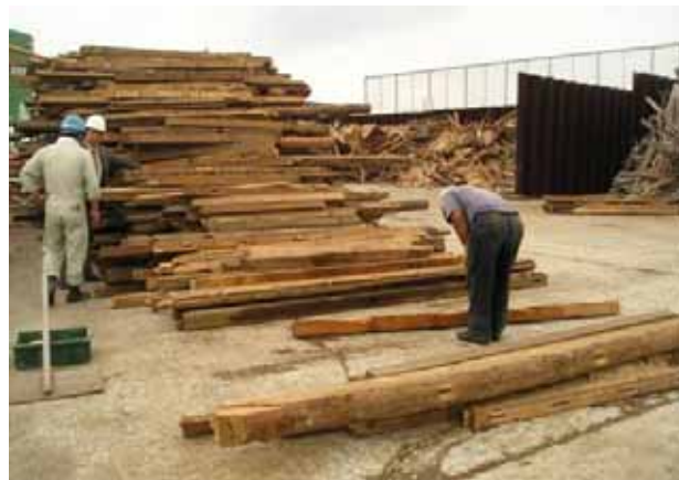
写真 4.5.2 柱材からの異物除去 (アルミニウム、ステンレス、プラスチック等の除去。釘、ボルト等は磁選機対応のため除去せず)
