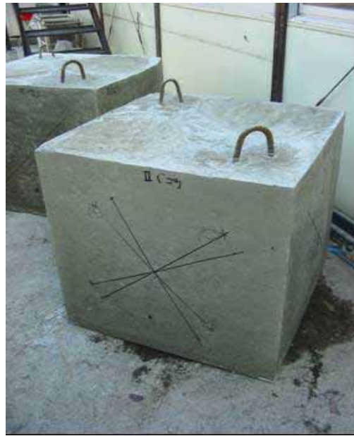
写真 3.3.24 コンクリートの表面状況 (廃木ボード 面)
