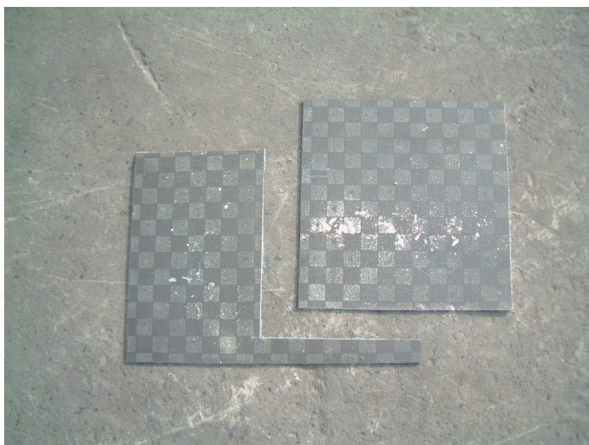
写真 4.5.9 柱回り等で発生する異形品の例
