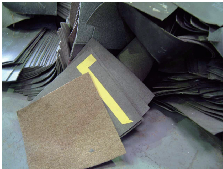
写真 4.5.5 改修工事時にマークとして貼り付けられた接着テープ
