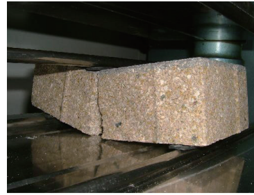
図 3.3.7 再生透水性セラミック ブロック曲げ試験状況
