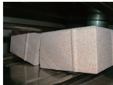
図 3.3.7 再生非透水性セラミックブロック曲げ試験状況
