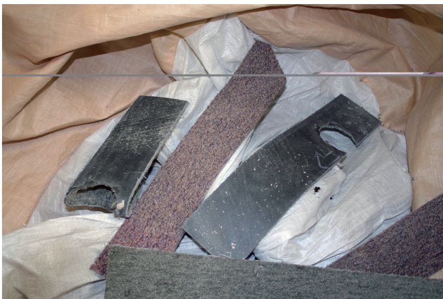
写真 4.5.7 一部寸法不足品を5分割した後の欠損品の例
