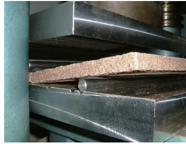
図 3.3.5 再生タイル曲げ試験状況
