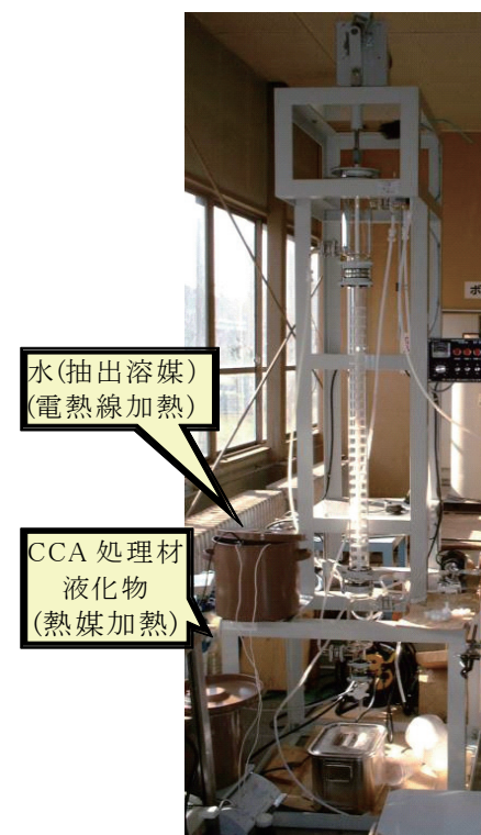
図 6.39 多段連続抽出装置 ※多孔板抽出塔による液-液向流抽出
