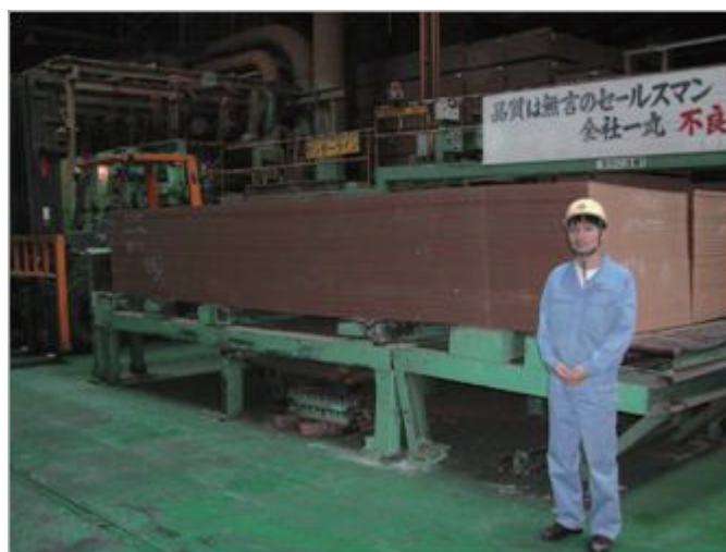
図 3.4.8 量産試作品原板全景(幅4尺×長さ18尺)
