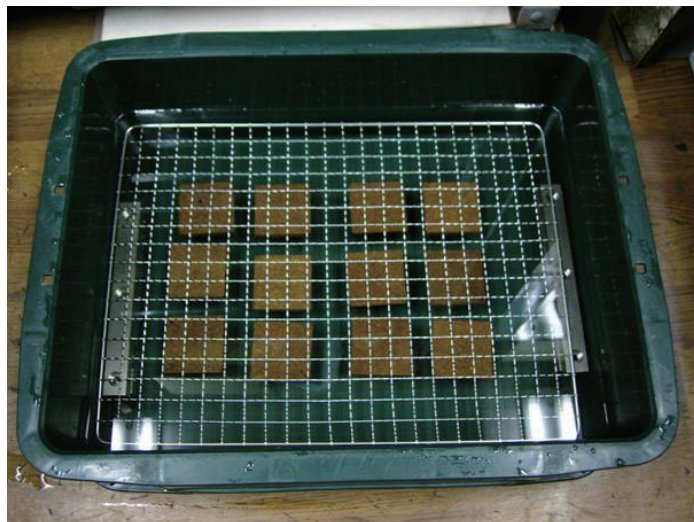
図 3.4.18 吸水厚さ膨張率試験風景
