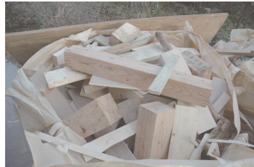
図 2.2.44 躯体材、小角材の端材
