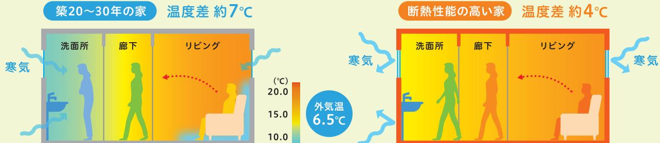
参考) 2020年を見据えた住宅の高断熱化技術開発委員会(HEAT20)を元に作成
