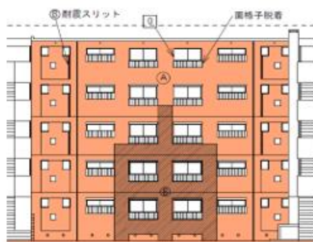
耐震補強 立面図(北面)
