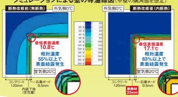
この計算条件では、最低表面温度 (赤丸部) は約6℃上昇し、 室内早退温度が83%以上にならないと表面結露は発
