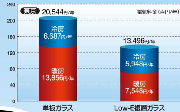
※図は、一枚ガラスとエコガラス (LE3+A6+FL3) の比較です。また、縦軸は冷暖房費(百円/年・戸)とし、一枚ガラス:冷房(67)+暖房(139)=205、エコガラス(FL3+A6+LE3):冷房(59)+暖房(75)=135とします。地域は、東京です。前提条件は、集合住宅モデル:延べ床面積:81.06㎡、開口部面積:11.16㎡、中間階中間住戸の基本モデル、換気:通年全室0.5回/hr、冷暖房費:灯油価格83円/リットル、従量電機料金:21.0円/KWh(板硝子協会試算)
