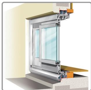
既存サッシ枠を残して、その上に新しいサッシ枠を被せる方法です。既存サッシの形状を事前に実測するので、ほとんどのサッシに採用できます。
