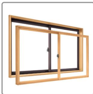
既存サッシの内側に樹脂製窓を取り付け、二重窓化する方法です。断熱性能が高まり、結露発生を抑えます。また騒音や音漏れ対策にも有効です。
