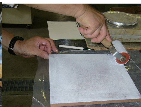
写真3. 接着剤のローラー塗布
