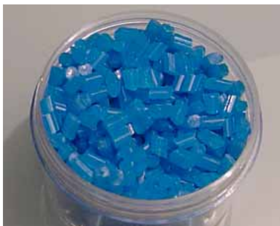
写真 5.2.1 コールドカットペレット 資料提供 石塚化学産業(株)
