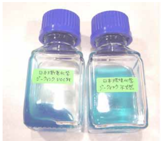
写真 5.2.5 ウェット方式で溶解されゲル化した ポリスチレンフォーム 資料提供 日本環境化学(株)
