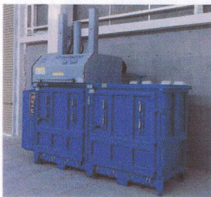
紙・段ボールなどに対応する汎用圧縮減容機
