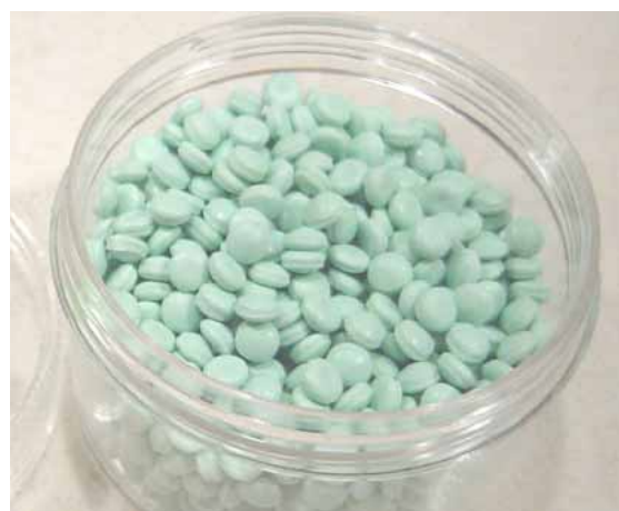
写真 5.2.2 ホットカットペレット 資料提供 石塚化学産業(株)
