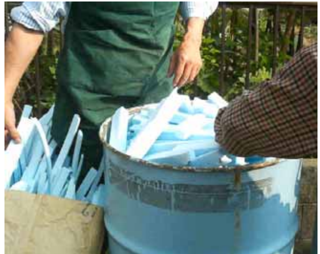
写真 5.2.4 ウェット方式ゲル化作業例 資料提供 日本環境化学(株)
