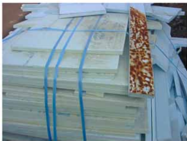
写真 3.3.1 長期に屋外に保管したため 錆び水によるシミ
