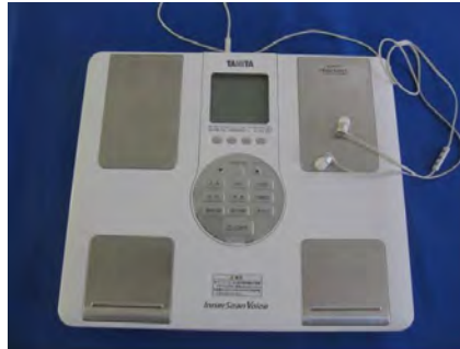
図 14 イヤホンジャック付き音声ヘルスマーター
