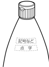
図 3 形状が類似した包装・容器の触覚識別表示における軟質ボトル肩部への点字、記号などの例
